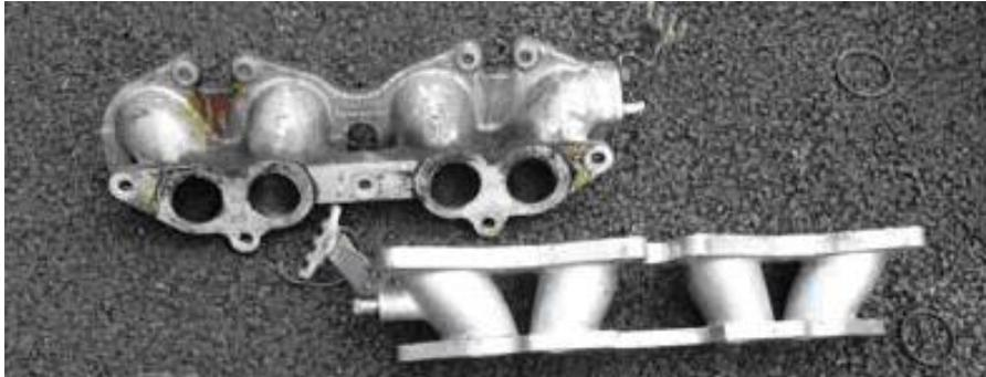
Photo 2 (en haut à gauche la pipe d'AX Sport et en bas à droite la pipe de 205 Rallye)
