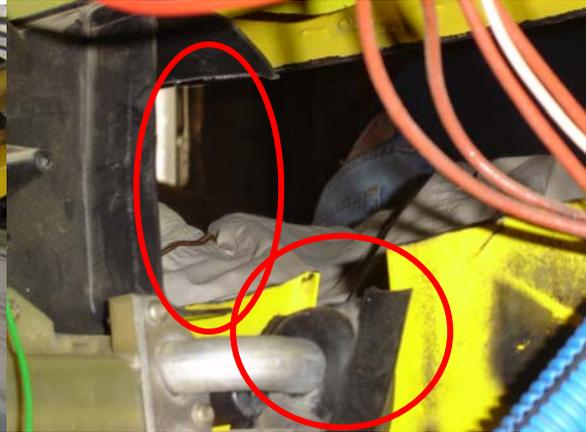
Il est nécessaire de découper le carter plastique du radiateur de chauffage et de faire passer les durits du radiateur de chauffage plus bas.
